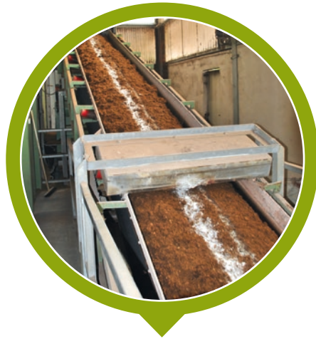
Im Erdenwerk werden Ausgangsstoffe wie Kompost, Torf, Ton je nach Bedarf gemischt.
